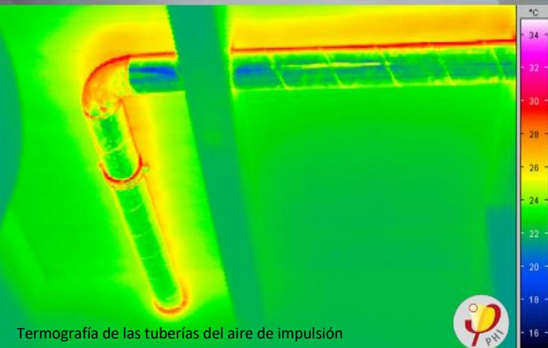
Termografía de las tuberías del aire de impulsión
