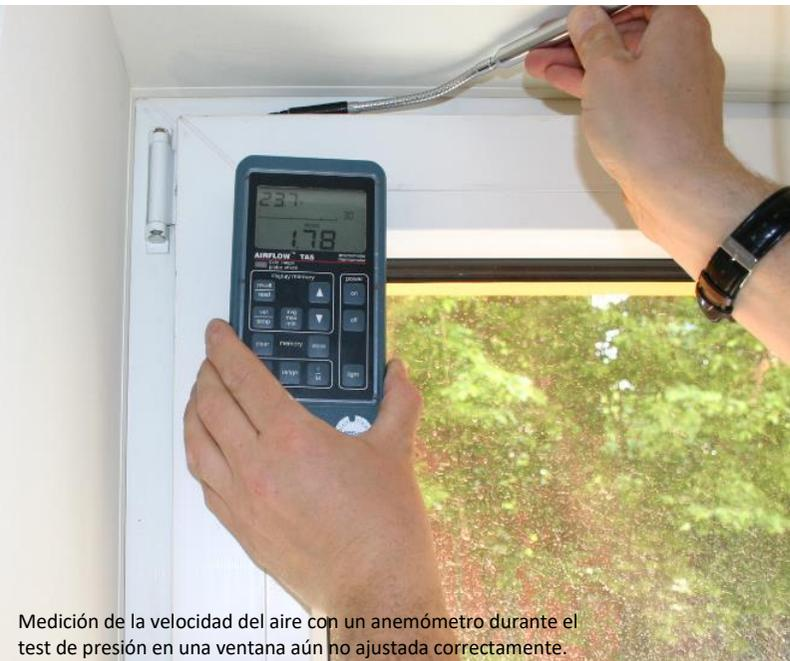
Medición de la velocidad del aire con un anemómetro durante el test de presión en una ventana aún no ajustada correctamente.
