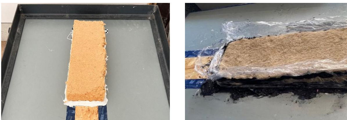
Abbildung 3: Holzweichfaserplatte mit Verklebung und ohne seitliche Abdichtung (links). Seitlich mit Folie abgedichtete und oben und unten verklebte Hanfdämmmatte (rechts)
