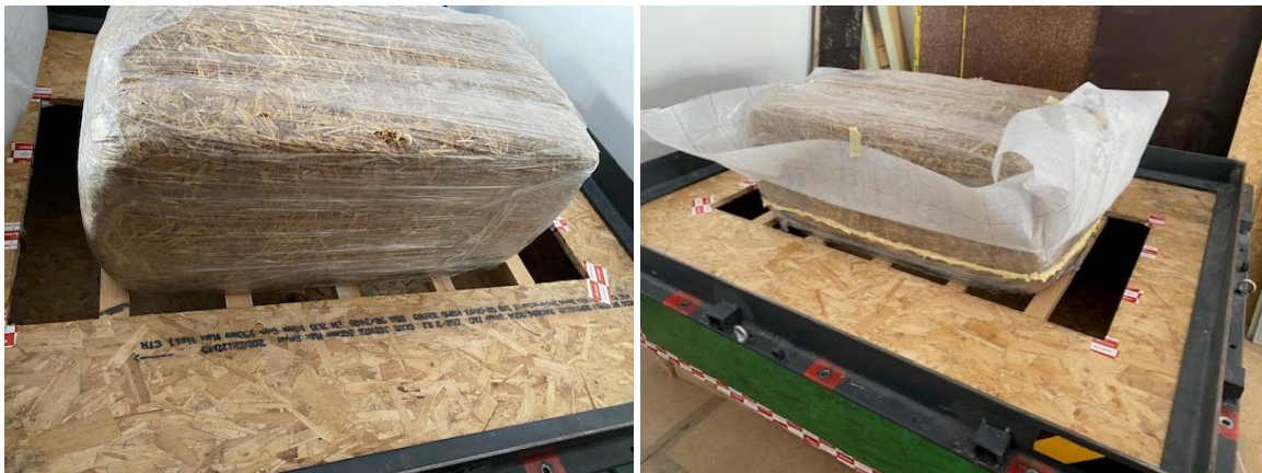
Abbildung 4: Gelieferter, mit Folie vollständig umwickelter Strohballen auf dem Prüfstand (links), überstülpte Folie und angebrachter gelber Anschlusskleber (rechts).
