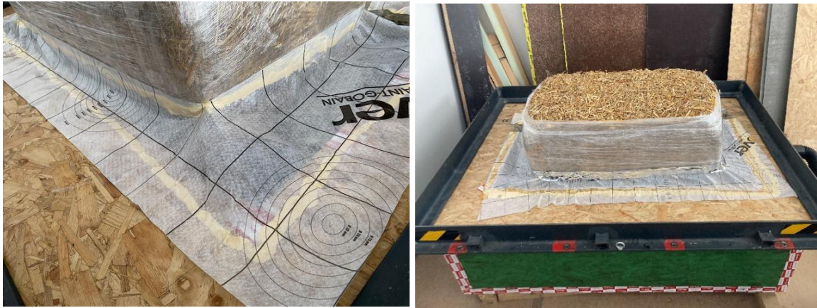
Abbildung 5: Strohballe mit verklebter Folienschürze (links) und fertig präparierte Probe mit offener Oberfläche auf der Ober- und Unterseite (Unterseite im Bild nicht zu sehen) (rechts).
