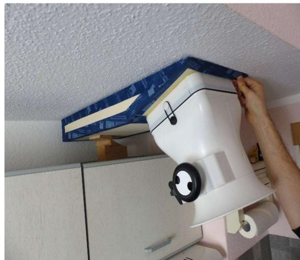
**Abbildung 16: Kalibriermessungen mit einem Volumenstrom-Messgerät mit Stützventilator (Prinzip: Nulldruckkompensation) vom Typ FlowFinder der Zu- und Abluftdüsen in einer der 12 Wohnungen. Aufgrund der eingeschränkten Zugänglichkeit über einem Küchenschrank musste für die Messung ein Adapter hergestellt werden (rechts).**
