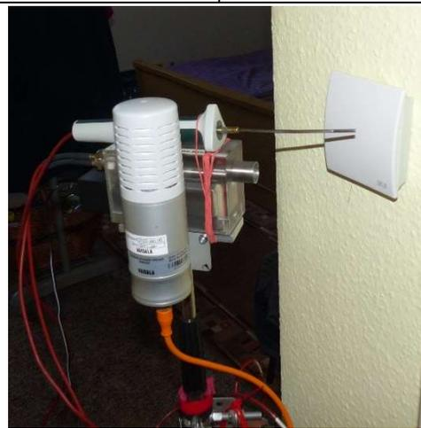
Abbildung 21: Wetterstation auf dem Dach des Gebäudes (links) und Wandsensor (T, rF, CO<sub>2</sub>) in einem Zimmer während der Kalibriermessung (rechts).
